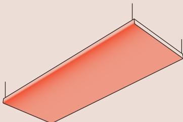
Per soffitti di larghezza (*direzione orditura*) superiore a 308 cm è presente un giunto, in cartone o alluminio, di 1 cm di spessore.
